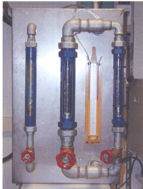
Bild 3b: Prüfstand-Steuerung (Wasser- u. Luftmenge)
