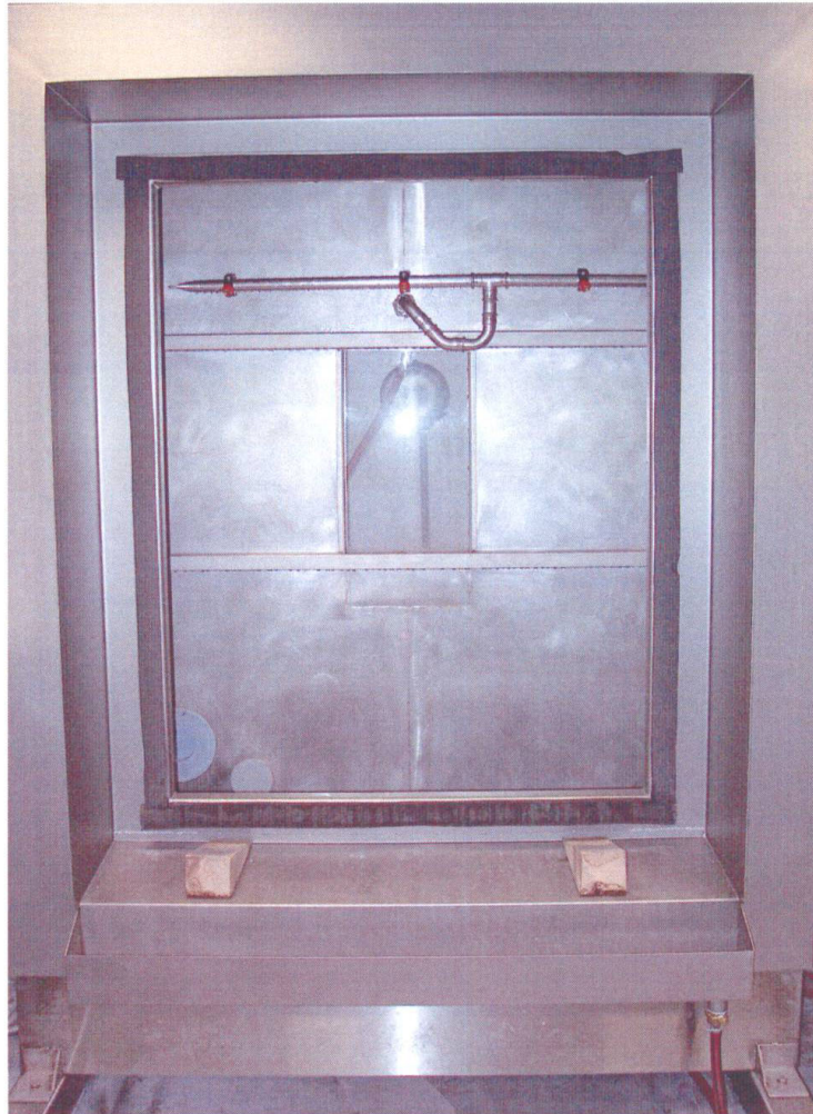
Bild 1: Offener Prüfstand ohne eingesetzte Versuchskörper
