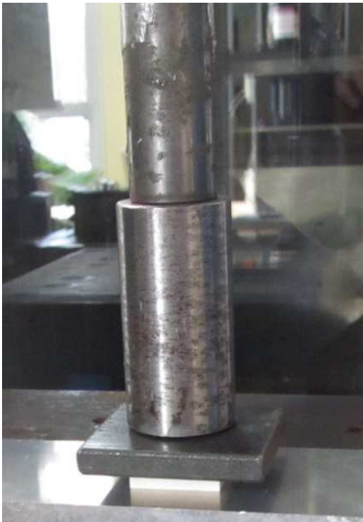
Bild 1 Prüfaufbau der Druckversuche
